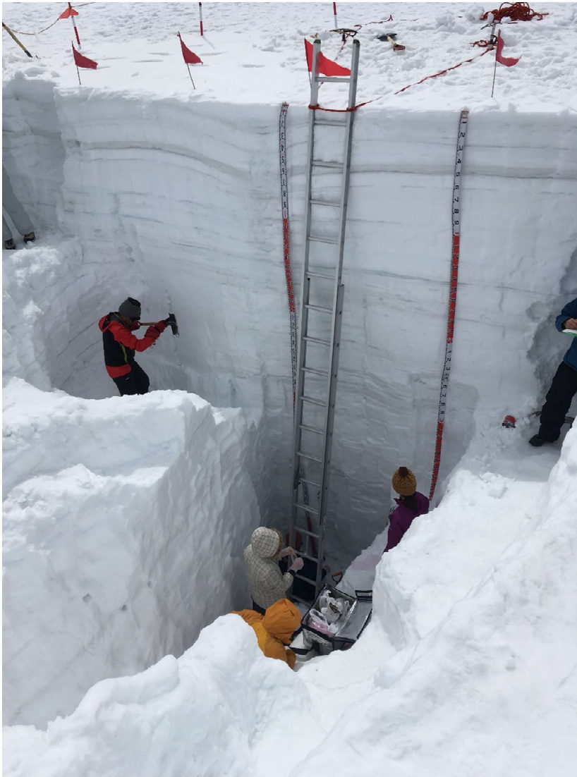
富山大学が実施している積雪断面調査 (2017/4/17) この日の積雪深は 5.88m
